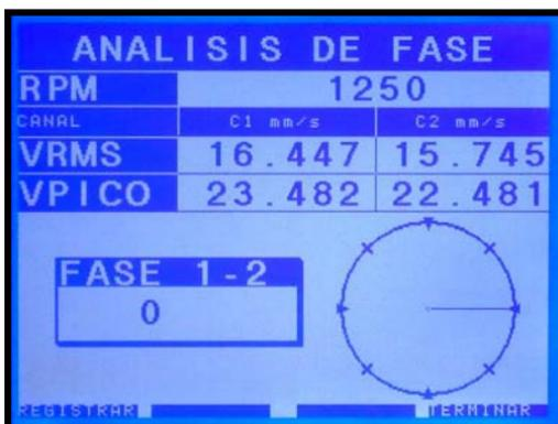
En esta pantalla se verá sobre la parte superior las RPM del equipo a analizar y por debajo una grilla donde se podrán leer los valores de velocidad de vibración en RMS y Pico tomados por cada sensor identificados como canal 1 (C1) al sensor conectado en la entrada del sensor 1 y canal 2 (C2) al sensor conectado en la entrada del sensor 2.
